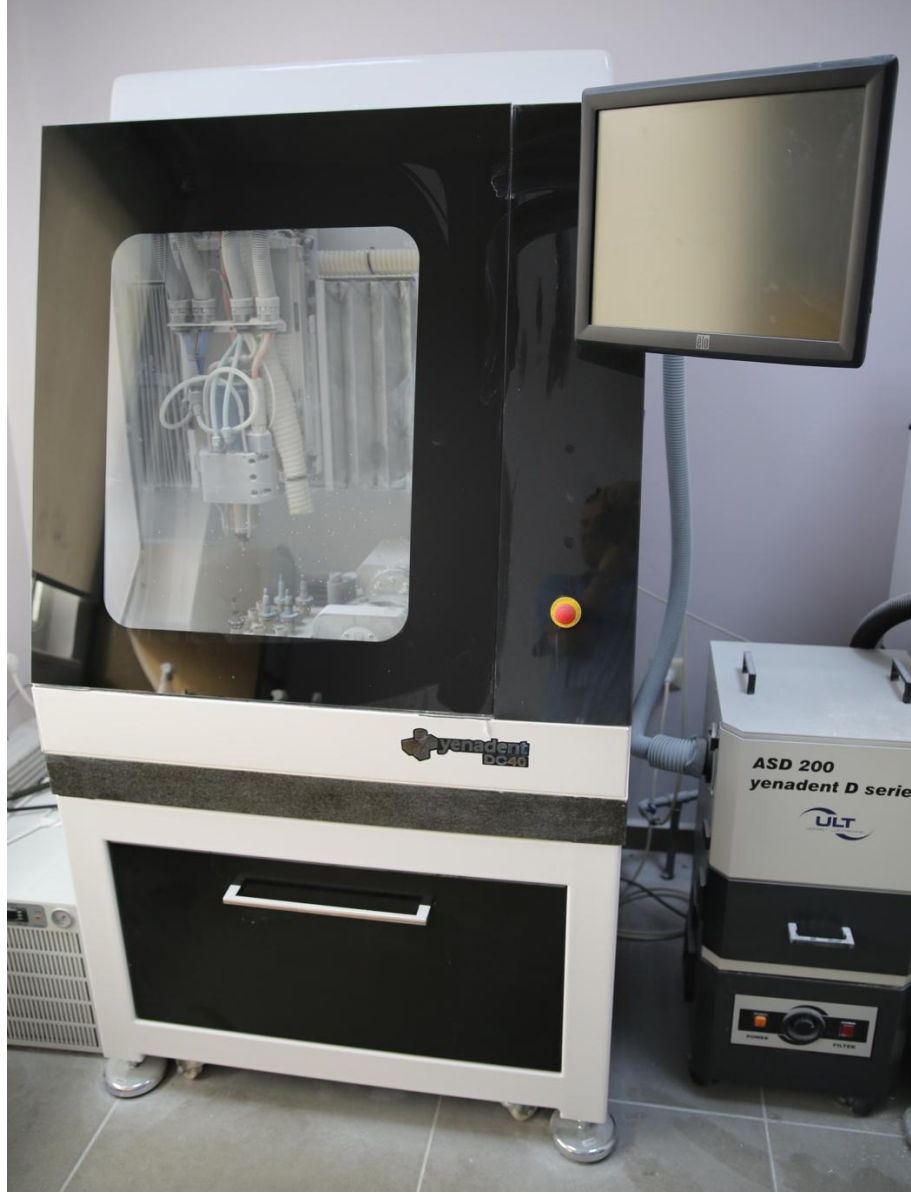
Şekil 3.12. Titanyum ve zirkonyum bloklardan implant üretimi için kullanılan dental CNC işleme cihazı
