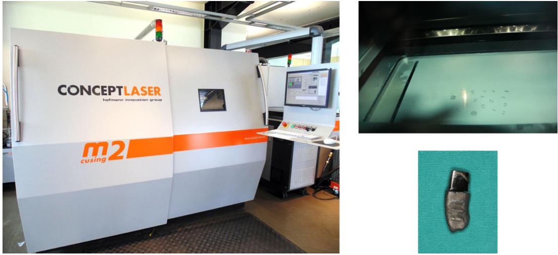
Şekil 3.15. Ti-6Al-4V tozundan DLMS yöntemiyle implant üretimi
