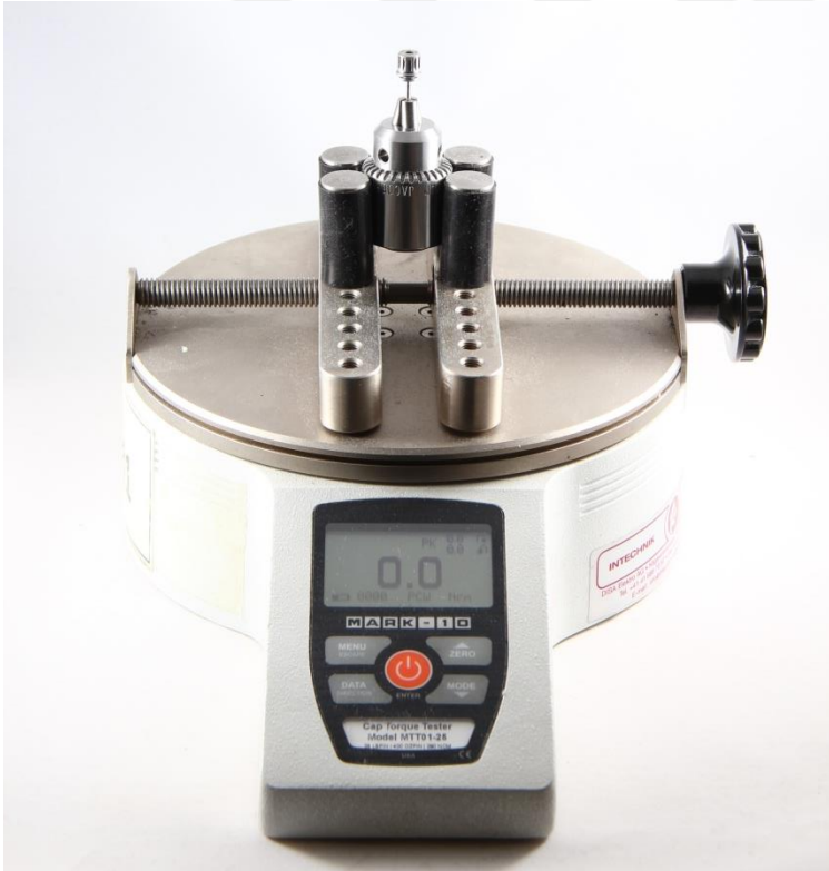
Şekil 3.19. Anahtarın 3 ağızlı kilit sistemine bağlanması
