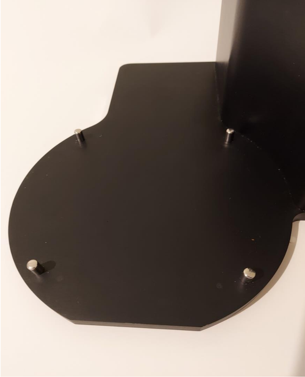
Şekil 3.11. Alt tablada bulunan dijital tork ölçerin yerleşeceği pinler
