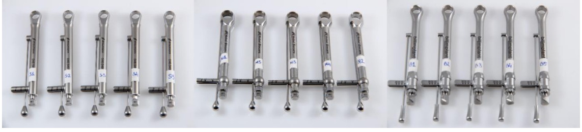
Şekil 3.1. Yaylanım tipi tork sınırlayıcı cihazlar ( Sırasıyla; Straumann, Nobel Biocare, Bilimplant)
