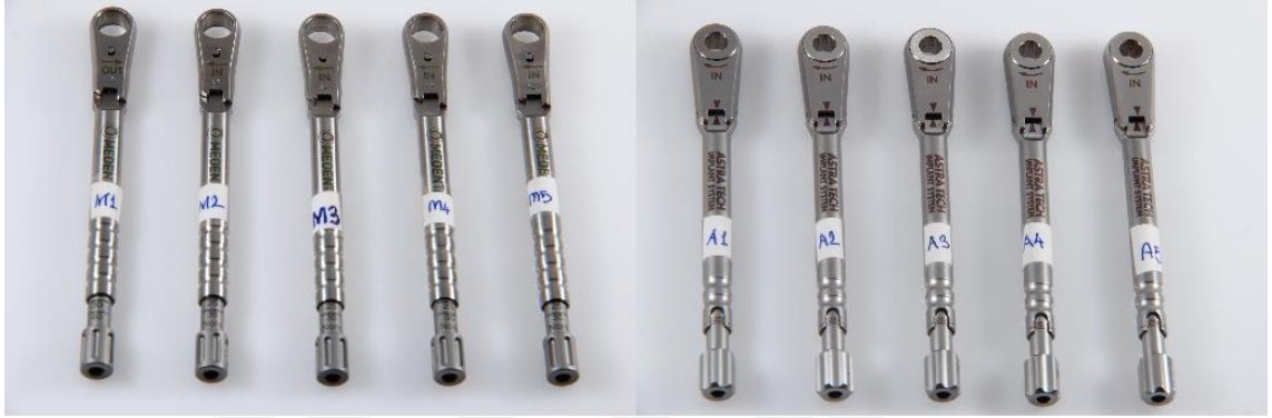
Şekil 3.2. Sürtünmesel tip tork sınırlayıcı cihazlar ( Sırasıyla; Medentika, Astra Tech)
