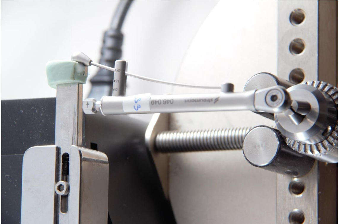
Şekil 3.21. Yaylanım tipi MTSC'lerin hedef torka göre ayarlanması
